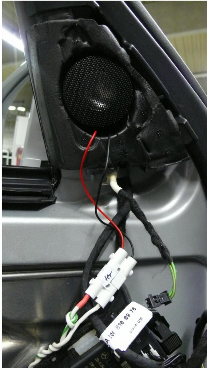
Die Lautsprecherleitung sollte jedoch nicht wie auf dem oberen Bild zu erkennen nach vorne rausgeführt werden sondern wie im nächsten Bild zu sehen nach hinten
