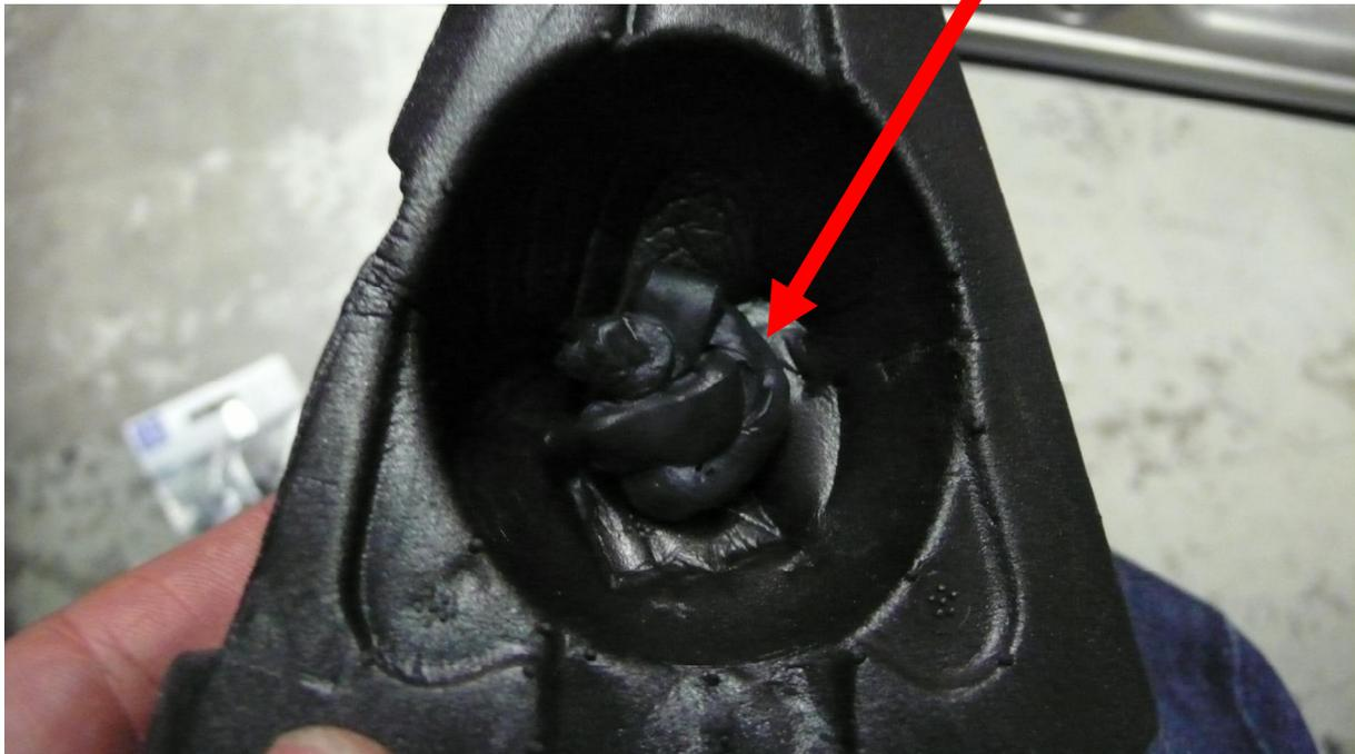
Damit das Lautsprechergitter wieder gut passt müssen die vorhandenen Halterungen für den original Hochtöner noch entfernt werden. Hierzu werden die Schweißpunkte einfach mit einem kleinen Seitenschneider entfernt.
