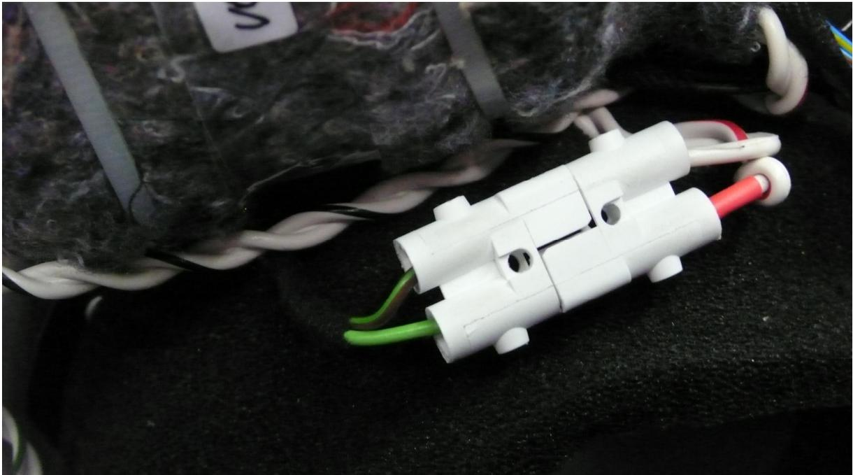
Steckverbinder von CONRAD. Diese werden zwar auch mit dem Kabel verschraubt sind aber trotzdem – weil steckbar – leider zu de(montieren)
