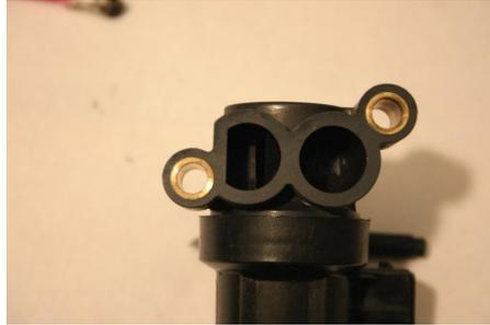
Abbildung 5: Drosselschieber in Ruhelage
