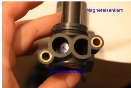
Abbildung 3: Drosselschieber wieder blank
