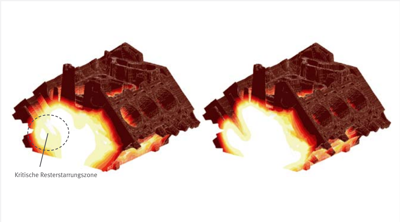
Abb. 13: Erstarrungs-Simulation am Beispiel des V6-ZKG Rechts: Resterstarrungszone (Gefahr von Lunkern) im Getriebeflanschbereich ohne aktive Kühlungsmaßnahmen Links: Optimierter Zustand; Vermeidung von Lunkern (keine Resterstarrungszone) durch gezielte aktive Kühlungsmaßnahmen
