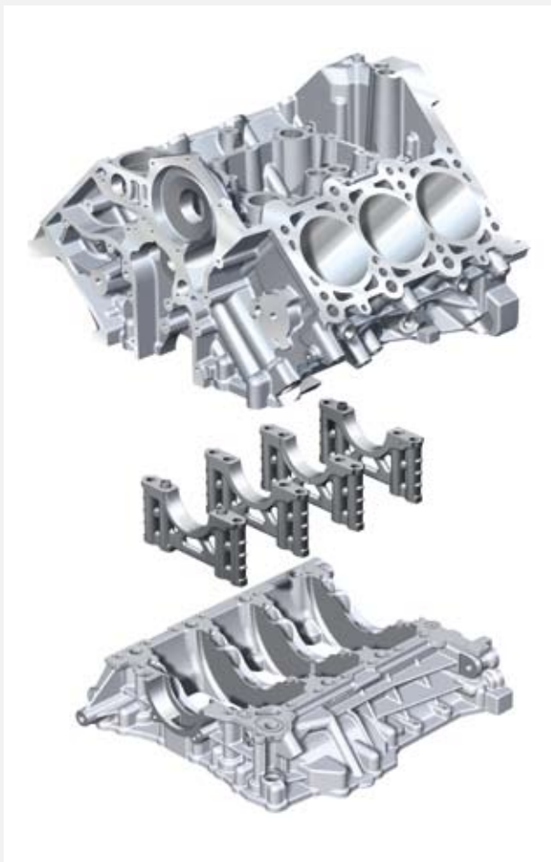
Abb. 10: Aluminium-ZKG-Konzept bestehend aus monolithischem ZKG-Oberteil und Bedplate mit eingegossenen Lagerstühlen aus Sphäroguss
