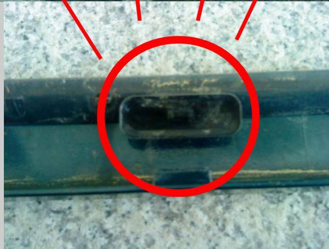
So sehen die Halteklipse (kleines Bild) an der Zierleiste aus und auf dem großen Bild ist die genaue Position der Klipse
