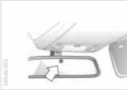
Das Gel reagiert chemisch auf diese elektrische Spannung und bewirkt ein stufenloses Abblenden des Spiegels (Elektro-Chrom-Technologie).
