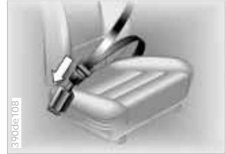
Der Gurtschloßstrammer sorgt dafür, daß bei einer Kollision der Gurt deutlich fester anliegt und den Körper sicher im Sitz hält. In Sekundenbruchteilen wird das Gurtschloß mit Hilfe von Gasdruck zurückgezogen, Schulter und Beckengurt werden dadurch gleichzeitig gestrafft. So wird dem Durchrutschen unter dem Beckengurt hindurch entgegengewirkt.
