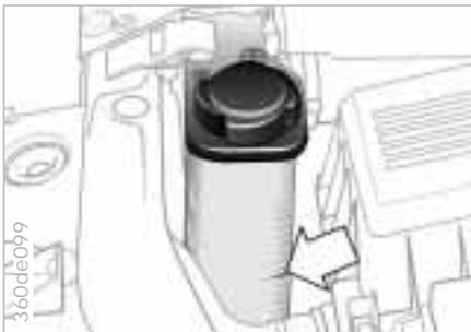
Das Bild zeigt beispielhaft den Kühlmittel-Ausgleichsbehälter der Fahrzeuge mit Benzinmotoren. Ausgleichsbehälter für Dieselmotoren, siehe Motorraum, ab Seite 108.
