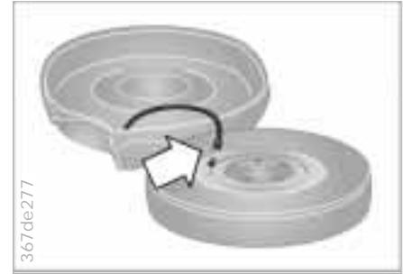
4 Das Ersatzrad mit dem Hebegriff bis zum Anschlag (Seilende) ablassen.
