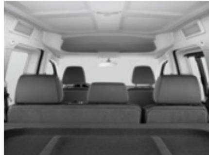
Der vollverkleidete Fahrgastraum. Für den großen Auftritt ist der gesamte Fahrgastraum hochwertig mit Kunststoff verkleidet. Ablagenetze im Dachrahmen sowie die Schublade unter dem Fahrersitz sorgen dafür, dass hier wirklich alles gut aufgehoben ist.
