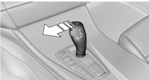
Wählhebel aus Getriebeposition D nach links drücken.
