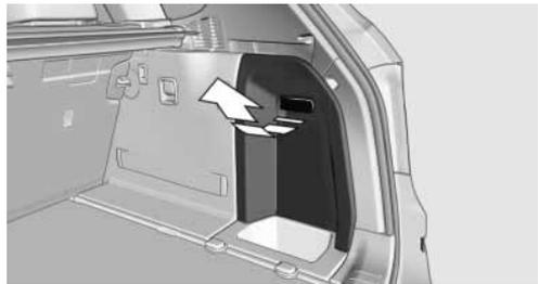
2. Grünen Knopf mit dem Tanksäulen-Symbol ziehen. Tankklappe wird entriegelt.
