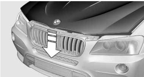
Aus ca. 40 cm Höhe fallen lassen und nachdrücken um die Motorhaube wieder vollständig zu verriegeln.
