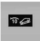
In der Instrumentenkombination wird die gewählte Wunschgeschwindigkeit angezeigt.
