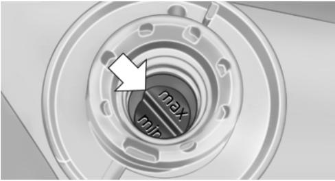
4. Bei Bedarf langsam bis zum korrekten Füllstand auffüllen, nicht überfüllen.
