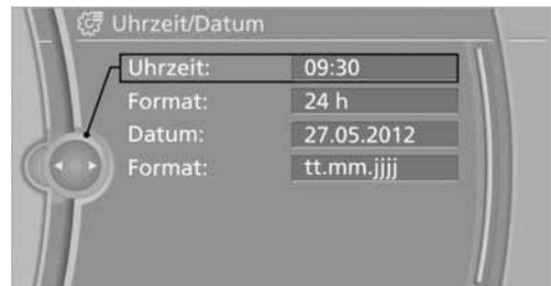
4. Controller drehen, bis gewünschte Stunden angezeigt werden.
