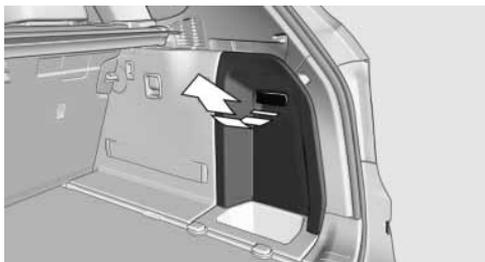
Die Taste zum Aus- und Einschwenken des Kugelkopfes befindet sich hinter der rechten Seitenverkleidung im Gepäckraum.
