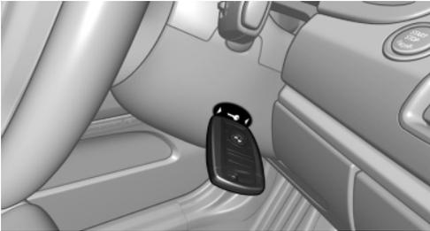
Bei entsprechender Check-Control-Meldung die Fernbedienung, wie abgebildet, an die Markierung an der Lenksäule halten und innerhalb von 10 Sekunden bei getretener Bremse den Start-/Stopp-Knopf drücken.
