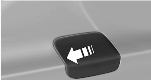
2. Tankverschluss gegen den Uhrzeigersinn drehen.
