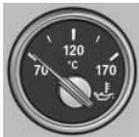
▶ **Kalter Motor:** Der Zeiger befindet sich am niedrigen Temperaturwert. Mit mäßiger Motordrehzahl und Geschwindigkeit fahren.
