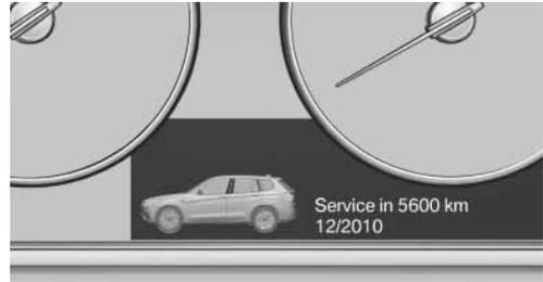
Die Fahrstrecke oder die Zeit bis zur nächsten Wartung wird nach Einschalten der Zündung kurz angezeigt.
