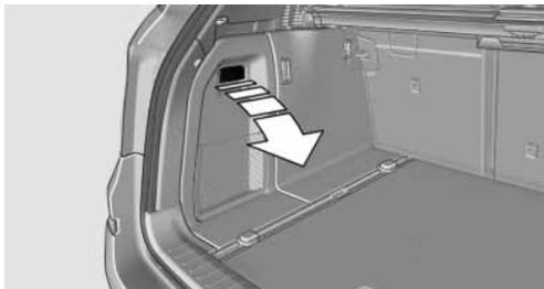
Das Bordwerkzeug befindet sich hinter der linken Klappe im Gepäckraum unter dem Verbandpäckchen.
