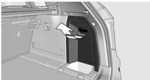
Abdeckung der rechten Seitenverkleidung aufklappen und die Schallisolierung abnehmen.
