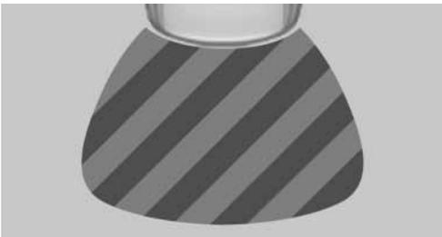
Am Control Display werden die Flächen vor und hinter dem Fahrzeug schraffiert dargestellt. PDC ist ausgefallen. System überprüfen lassen.
