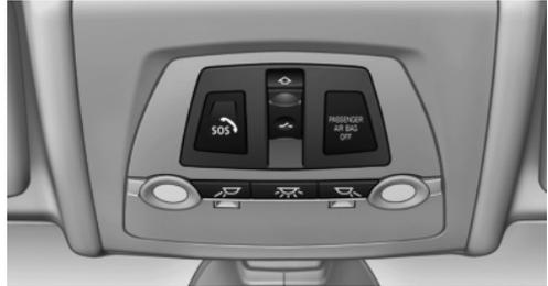
1. Zum Öffnen Abdeckklappe antippen.
