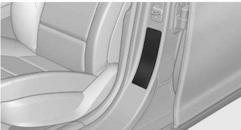
Druckangaben für freigegebene Reifengrößen befinden sich an der Türsäule der Fahrertür.
