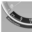
Bewegungsenergie des Fahrzeugs wird bei Schubetrieb in elektrische Energie umgewandelt. Die Fahrzeugbatterie wird teilweise aufgeladen und der Kraftstoffverbrauch kann gesenkt werden.
