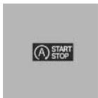
Die Anzeige in der Instrumentenkombination signalisiert, dass die Auto Start Stop Funktion zum automatischen Motorstart bereit ist.
