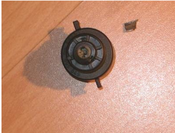
Abb.1 gebrochener Zapfen und als mögliche Ursache defekter Zündschalter (gebrochen)
