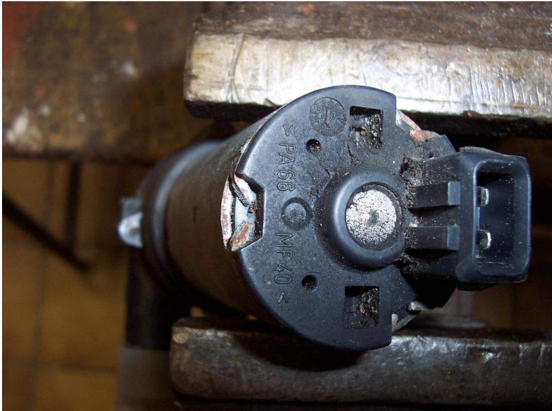
Zunächst wird die Pumpe vorsichtig (!) in den Schraubstock gespannt. Dabei darf man auf keinen Fall das Gehäuse verbiegen, sonst ist die Pumpe Schrott. Der hintere Deckel ist mit Laschen gesichert, die mit einem Schraubendreher so verbogen werden, dass sich der Deckel abnehmen lässt.
