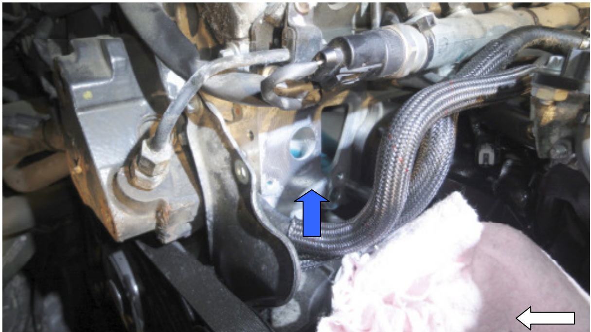
Das Bild zeigt, die Stelle am Motor wo das Thermostat ausgebaut wurde. weißer Pfeil = Lampen im Ölfilterloch blauer Pfeil = Stelle wo das neue Thermostat hinkommt.
