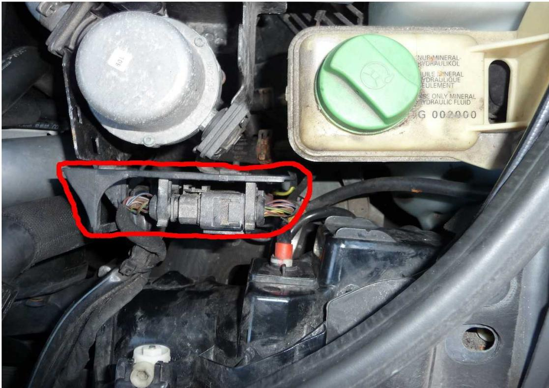
Hierzu mit einer Wasserpumpenzange die untere Halteklammer (1.) vorsichtig zusammendrücken und nach vorne leicht heraus drücken und die beiden Klemmlaschen (2. + 3.) mit einem Schraubendreher vorsichtig austrasten (Vorsichtig vorgehen, da die Laschen evtl. schon spröde sein können und leicht abbrechen).
