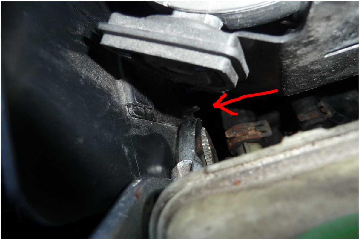
3. Danach die Steckerplatte zur Seite schieben und man hat jetzt genug Platz (selbst mit großen Händen) um die hintere Gehäuseabdeckung zu entfernen und den Brenner zu tauschen.
