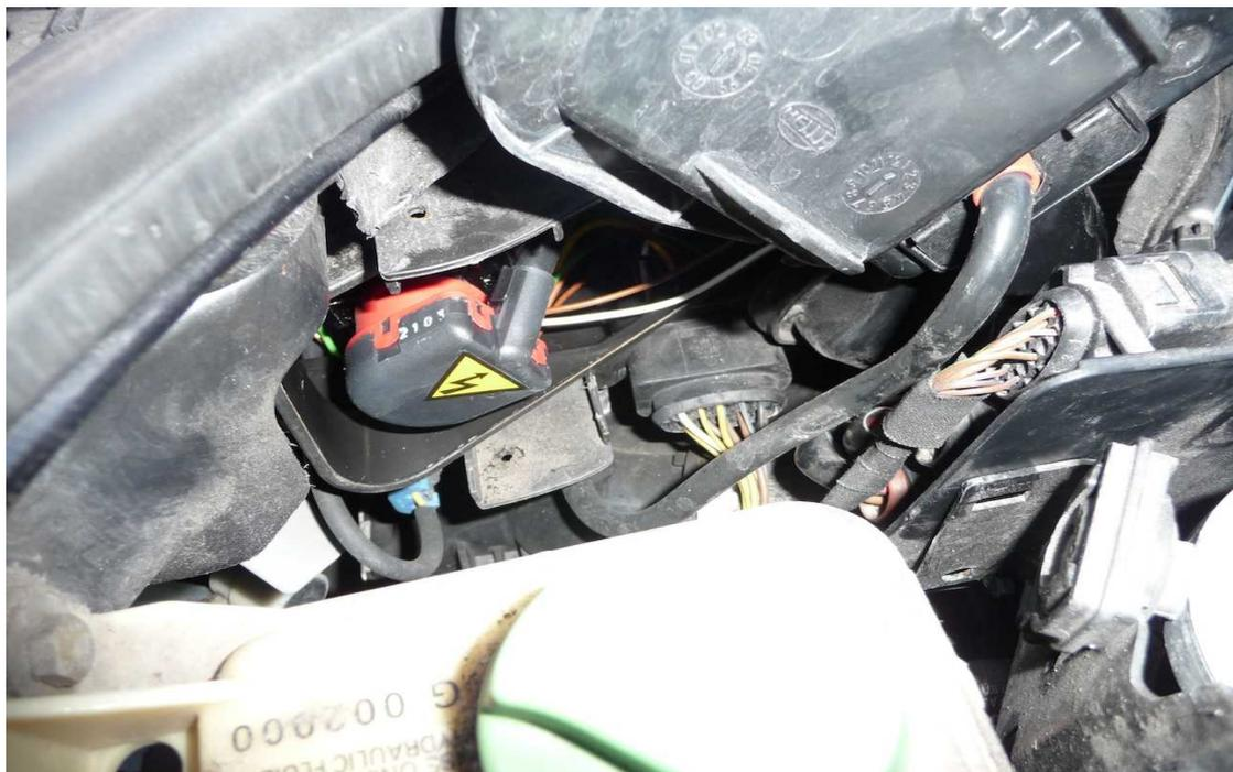
4. Den Stecker vom Brenner in Fahrtrichtung gesehen im Uhrzeigersinn um ca. 45° drehen und abziehen. Danach die Überwurfmutter des Brenners lösen und den Brenner heraus nehmen.
