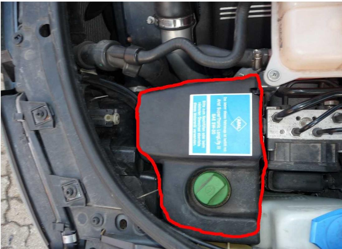
2. Danach diese Steckerplatte demontieren.
