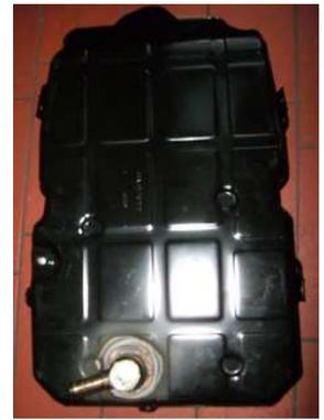
Einbau eines Ölablaßhahnes in die Ölwanne zum Ablassen des Restöles nach dem Leerpumpen auf dem Rollenprüfstand. Somit muß die Ölwanne zum Entleeren nicht abgebaut werden!
