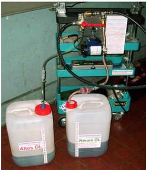
Nun sind ca. **6 Liter Altöl** im Kanister **Altes Öl** bei **kleinem Wärmetauscher**.
