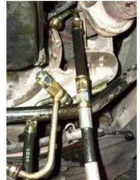
Adapter an Vito mit Getriebe 722.6 **nur über Hohlschraube.**
