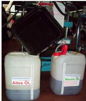
**oder** es sind ca. **7 Liter Altöl** im Kanister **Altes Öl** bei **großem Wärmetauscher**.
