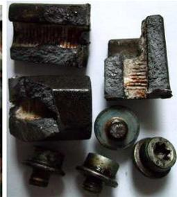
Bei den älteren 722.6 Getrieben der Benzinier (diese haben keine Kunststoffabdeckung unten) korrodieren die Schrauben der Ölwanne in den Aluabstandhaltern total fest. Beim Öffnen werden die Schraubenköpfe abgedreht. Am Besten, man spaltet mit einem Meißel die Aluabstandstücke auseinander. Dann wird mit zwei gekonterten Muttern die restliche Schraube ganz einfach herausgedreht. So geht es am schnellsten. **Wegen Gehäusebruchgefahr geht das nicht bei der Schraube am EGS-Stecker!** Notfalls Auspuff
