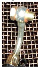
2 Dichtringe unterlegen (da sonst undicht)
