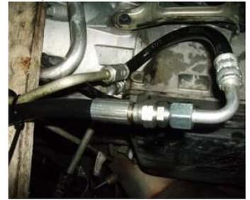
Beim **Neuen Sprinter / Chrysler 300C 3.0 CRD 5G** mit Steckein-satz in der Hohlschraube, das 7-G Stecksystem (der B-Klasse) montieren. **Achtung:** beim 300C V8 geht der Ölstand nur mit dem Ölpeilstab von Chrysler zu messen!
