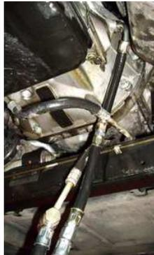
Adapter W163, ML 400CDI V8, Adapter AMG ML55. Dazu muß für den ML eine andere Hohlschraube (im Bild oben) verwendet werden.
