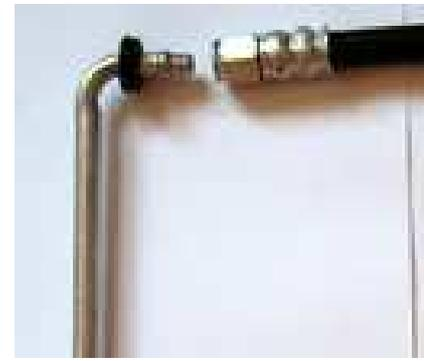
Dann die Leitung an beiden Seiten, wie im Bild abgebildet, absägen. Innen und außen die Leitung gut entgraten und mit Druckluft die Späne entfernen. Die Mutter und den Schneidring wie im Bild in Position bringen. Dann den beidseitigen Stutzen ansetzen und mit der Mutter verbinden. Wenn die Mutter anliegt, darf diese nur noch genau um 360 Grad festgeschraubt werden, damit der Schneidring richtig dicht sitzt.
