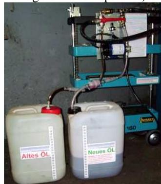
Start des Wechsels mit z.B. 9 Liter Neues Öl in der Wechselstellung z.B. W210 Vierzylinder mit kleinem Wärmetauscher (Hebel waagrecht). (722.7/CVT-Getriebe: 7L Öl). Bei Adaption an der 17/19mm
