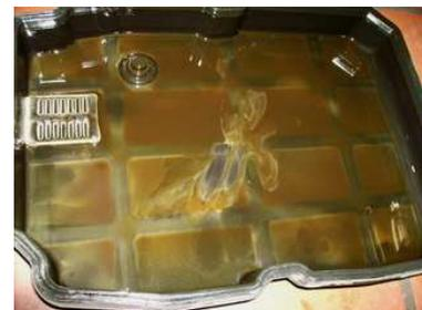
MB-Glykoltest für z.B. W203, W209, W211 **OK** bis **100 mg pro Liter Öl**. Über 100mg pro Liter Öl, Kühler tauschen und Getriebe spülen. Wenn durch die Spülung keine Besserung empfiehlt Daimler den Tausch des Wandlers!!!
