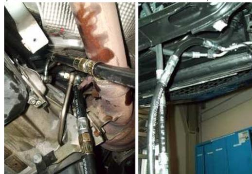
W211 5-Gang am Getriebe angeschlossen, oder wenn möglich vorne am Wärmetauscher.
