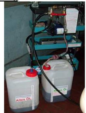
Ölwanne wird bei laufendem Motor +Gang D (S-Modus)(funktioniert) nur, wenn Alle Antriebsräder blockiert sind/kein Gas geben, von ca...Wenn viel Luft kommt in W/C-Modus schalten, dann Gang R + Motor aus.
