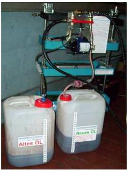
5,5 Liter **Altöl** leer gepumpt bei **kleinem Wärmetauscher**. (Evtl. danach: Hat der Wandler eine Ablassschraube, kann das Öl zusätzlich in den Kanister **Altes Öl** abgelassen werden).
