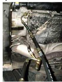
den **linken** Schlauch mit gebogenem Ringaugenanschluß links (Vorlauf) montieren. Den **rechten** Schlauch an den Schlauch zum Wärmetauscher montieren.
