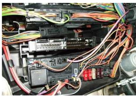
Wenn der EGS-Stecker stark undicht war, **dann bei Zündung aus**, z.B. am W210/W203 das EGS-Steuergerät auf **ÖL** kontrollieren. W211 hat schon normalerweise Ölsperren im Kabelbaum!
