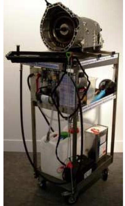
Zusatzwanne für Werkzeug/ Schrauben etc., Aufhänger für die beiden Schläuche mit Hydraulikschnellverschlußkupplungen. Aufhänger für 2 Ölpeilstäbe, Ölwannendichtung etc.. 2 Absperrhähne für die 2 Ölwannen. Auf Sonderwunsch eine Aluwanne (zum Auffangen des Restöles) für den liegenden Transport.
