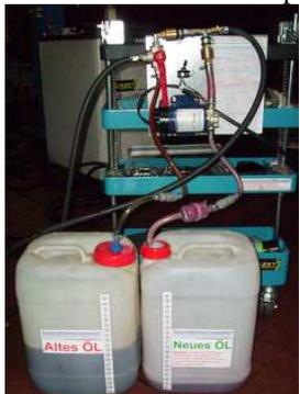
**oder** Umschalten in die **Durchgangsstellung** bei Erreichen der **10,4 Liter Altöl** (incl. **400 Vorreiniger**) bei **großem Wärmetauscher**.
