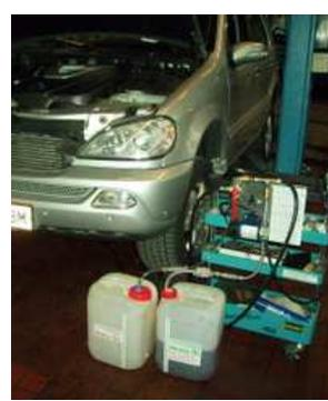
Start mit 10/(9) Liter Neues Öl z.B. am W163 ML400CDI in der **Wechselstellung** (Hebel waagrecht).
