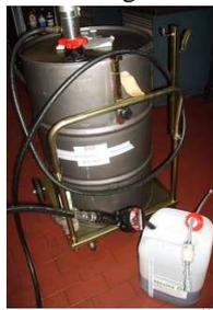
10 Liter Neues Öl in den Kanister Neues Öl abzapfen. (9 Liter Neues Öl bei kleinem Wärmetauscher).
