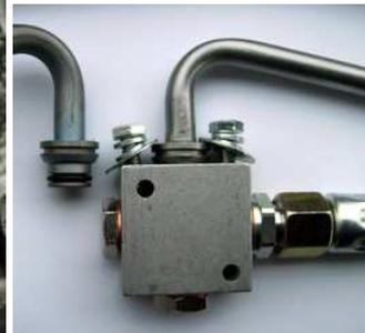
**Neu:** Gegenstückadapter SLK/CLK/ W203/W211-7G. Damit ist die Montage viel einfacher, da nicht mehr die Leitung am Getriebe montiert werden muß! 10€
