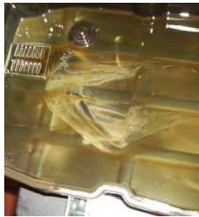
Abbau der Ölwanne. Dafür muß die Ölablassschraube nicht entfernt werden. **Altöl** des Ölfilters+Ölwanne auffangen. Ölfilter+Dichtung wechseln. (Abriebsschlamm in der Ölwanne).
