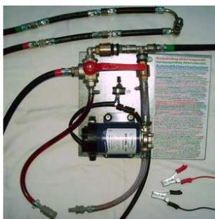
**Wechselstellung (Hebel waagrecht)**
