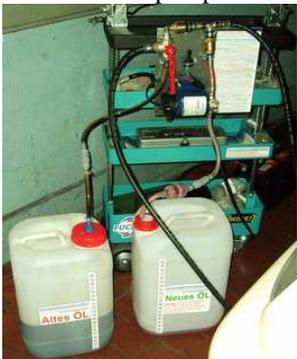
Umschalten in die **Durchgangsstellung** bei Erreichen der **9,4 Liter Altöl** (incl. **400 ml Vorreiniger**), bei **kleinem Wärmetauscher**.
