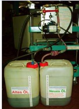
**oder** Ölwanne wird bei stehendem Motor mit **4 Liter Neues Öl** befüllt (**6 Liter Marke** bei **großem Wärmetauscher**) durch einschalten der **12V Ölpumpe**.
