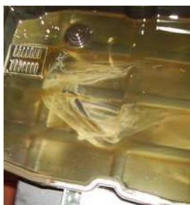
Abbau der Ölwanne. Dafür muß die Ölablaßschraube nicht entfernt werden. **Altöl** des Ölfilters+Ölwanne auf-fangen. Ölfilter+Dichtung wechseln. **0,3-0,5** Liter Rest **Altöl** aus der Ölwanne + Ölfilter in den Kanister (**Ablaßbahn der Service-station kurz öffnen**)
