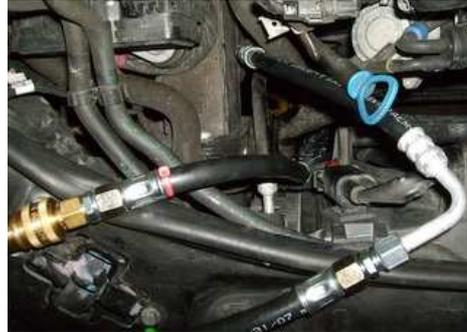
W221 unten am Wärmetauscher (Rücklaufleitung).
