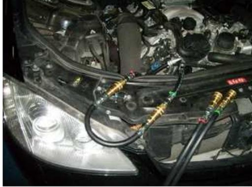
Während des Testes überbrücken der eingebauten Adapter. Dank Schnellverschlußadaptersystem kann innerhalb von Sekunden das Spülsystem wieder dazwischengeschaltet werden und schon kann innerhalb weniger Minuten auf dem Rollenprüfstand komplett auf ein anderes ATF-Öl umgeölt werden.
