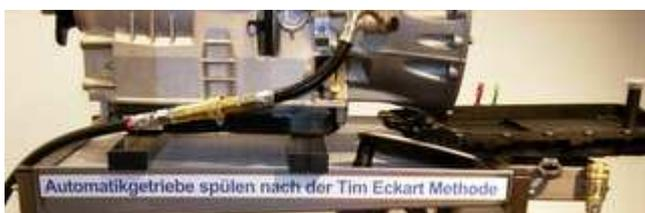
Montageauflage für die Ölwanne zum Wechseln der Ölwannendichtung.
