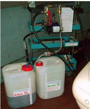
Restliches **Neues Öl** einpumpen. **12V Ölpumpe** ausschalten. **9 Liter Neues Öl** eingepumpt bei **kleinem Wärmetauscher**. Ölstandskontrolle ca. **55°**. Korrektur mit dem System,
