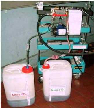
Ölwanne wird bei stehendem Motor mit **4 Liter Neues Öl** befüllt (**5 Liter Marke** bei **kleinem Wärmetauscher**) durch einschalten der **12V Ölpumpe**.
