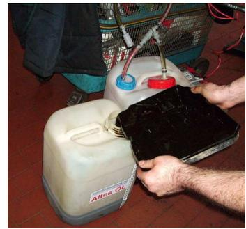
**0,3-0,5 Liter Rest Altöl** aus der Ölwanne+Ölfilter in den Kanister **Altes Öl** einfüllen (**Ablabahn der Servicestation kurz öffnen**). Falls kein **Magnet** vorhanden ist: **Ohne Magnet** können sich **Eisenspäne** auf den magnetischen **Drehzahlfühlern** festsetzen Die Folge kann ein **Getriebetotlauf** sein(Drehzahlvergleich unplausibel). Dann abbauen+**Drehzahlfühler** von **Metallspänen** säubern!
