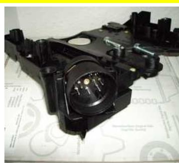
Elektroteil mit magnetischen Drehzahlfühlern.
