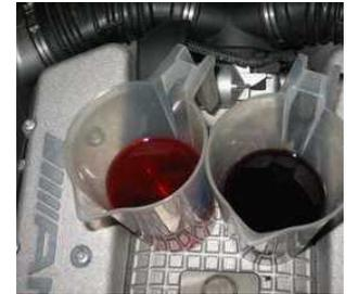
Altes Automatikgetriebeöl aus AMG G55, 2/2006, 25.600km..
