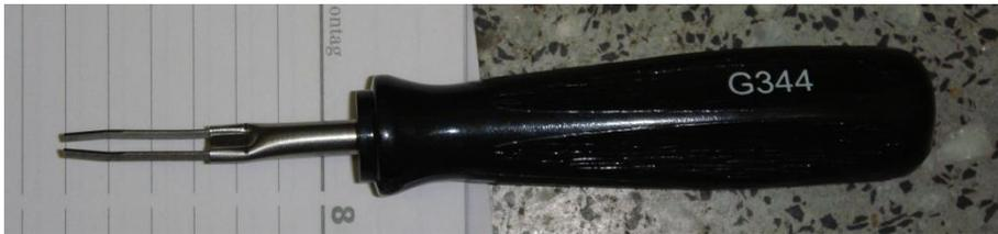
Abbildung 15: Entriegelungswerkzeug TGS G344
