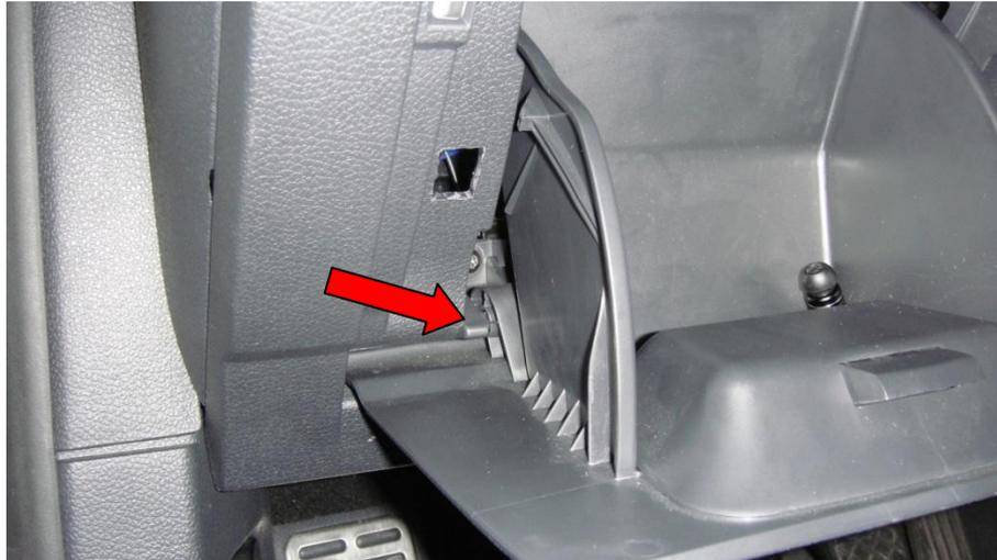
Abbildung 11: Ablagefachausbau
