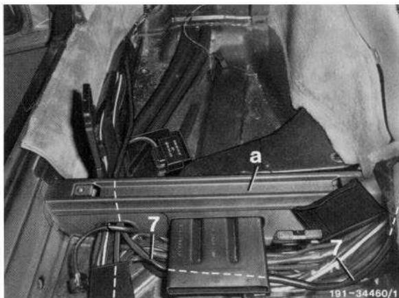
14 Ausbindung des Zusatzleitungssatzes mit den zwei 6poligen Kupplungen zur Mittelkonsole verlegen.
