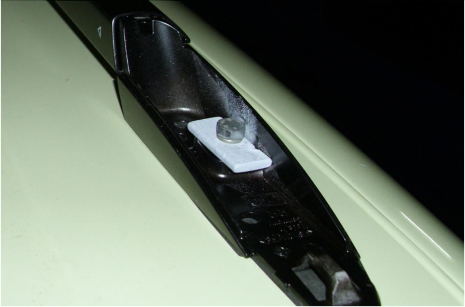
In der Mitte wird nur eine Madenschraube auf den Stehbolzen gedreht.
