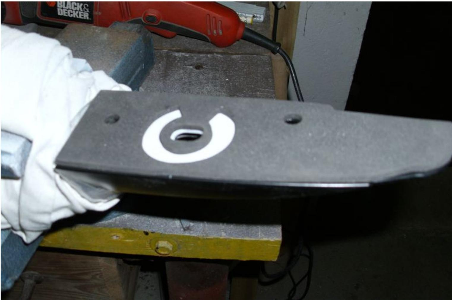
Danach kommen die Stehbolzen ins Dach und die Reling wird mit den vorderen Schrauben erstmal handfest angeschraubt. Nun lassen sich die hinteren Löcher bestens anzeichnen.
