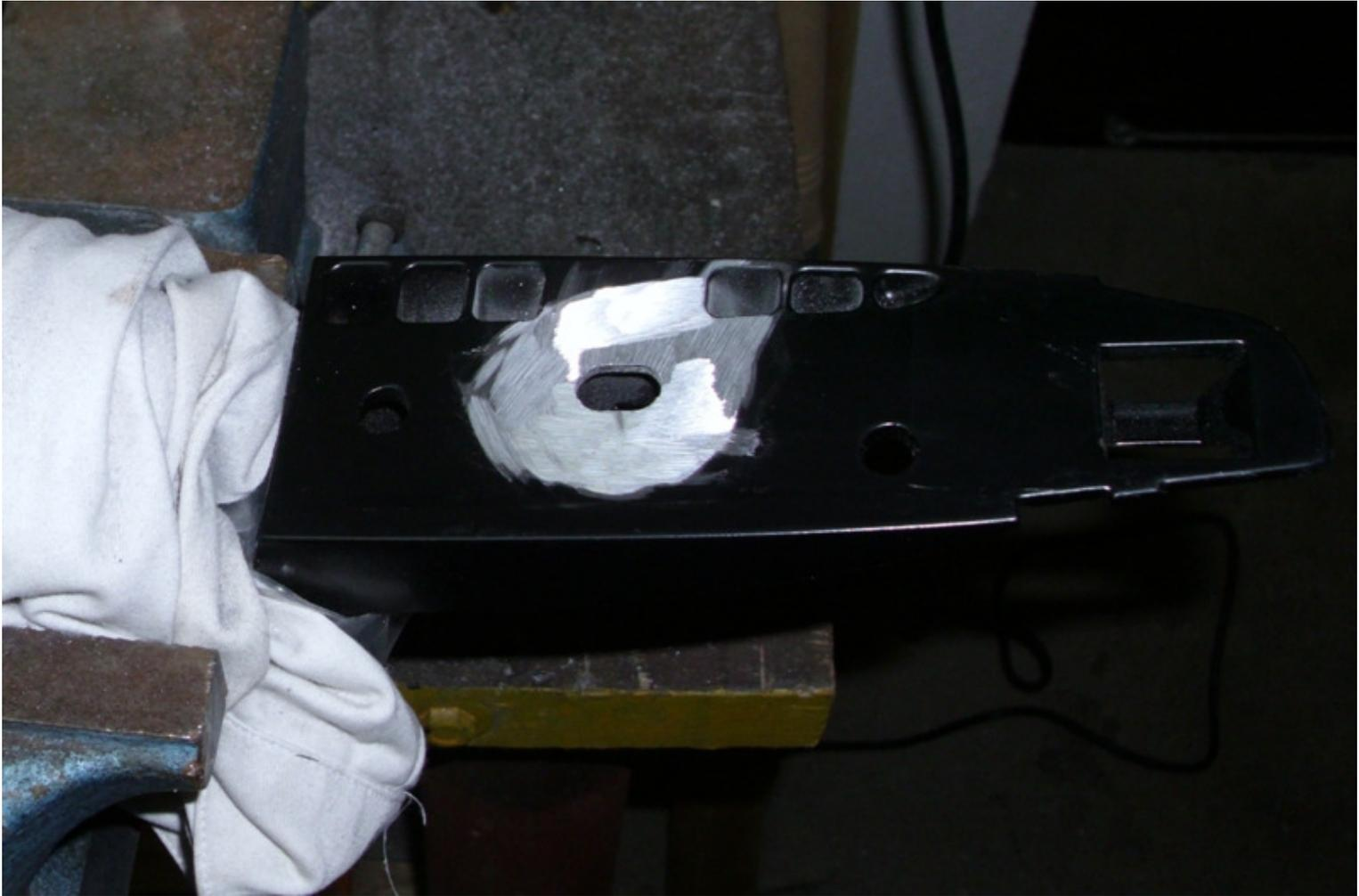
Noch etwas Farbe zum Korrosionsschutz drauf und den Moosgummi wieder ran.
