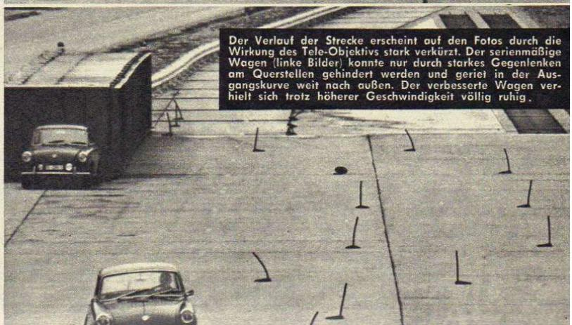
Der Verlauf der Strecke erscheint auf den Fotos durch die Wirkung des Tele-Objektivs stark verkürzt. Der serienmäßige Wagen (linke Bilder) konnte nur durch starkes Gegenlenken am Querstellen gehindert werden und geriet in der Ausgangskurve weit nach außen. Der verbesserte Wagen verhielt sich trotz höherer Geschwindigkeit völlig ruhig.
