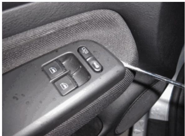
Nun löst bitte die Kabelverbindung für die FH und ZV. Ist ebenfalls geclipst.
