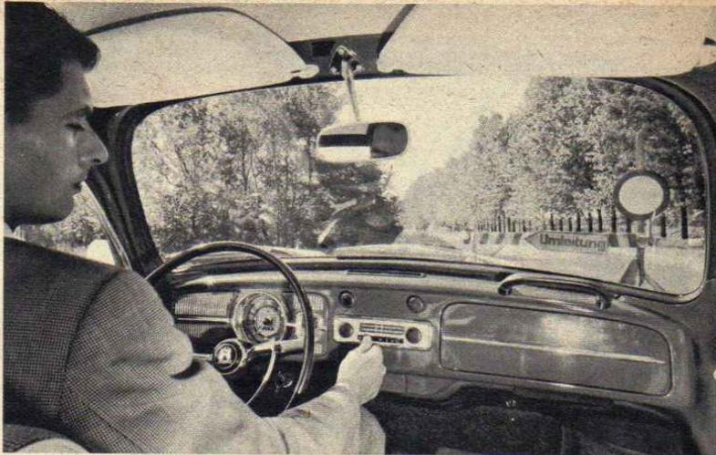
*Am Armaturenbrett wurden im Interesse der inneren Sicherheit abgeflichtete Schalterknöpfe eingeführt. Neu ist auch ein Radio, das ins offizielle Zubehörprogramm des Werkes einbezogen wurde.*
