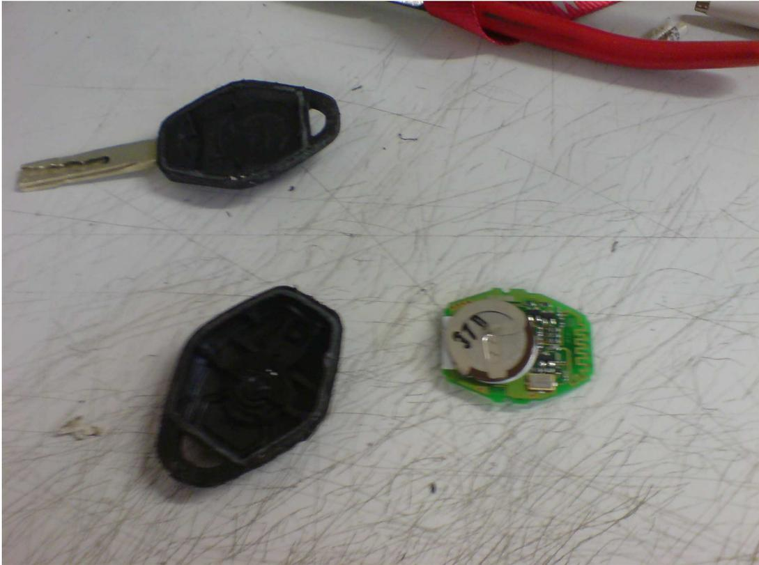
3. Man begutachtet die Platine und schaut wo der Akku fest gelötet ist. Diese stellen lötet man frei. Den Zinn sollte man wirklich sofort absaugen, damit nichts die Platine stören kann bzw. später der Strom falsch geleitet wird.
