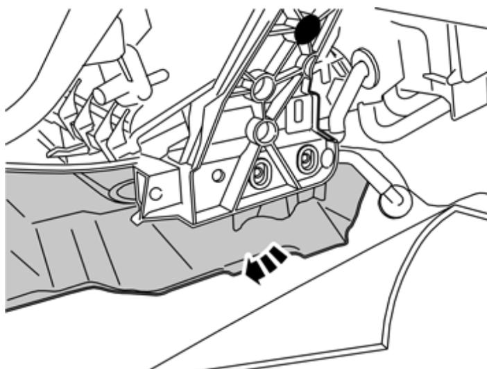
Die Isoliermatte ab der rechten Befestigung der Mittelkonsole zurückklappen.
