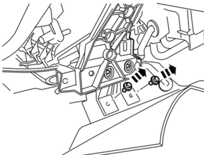
Die beiden Schrauben in der Befestigung der Mittelkonsole entfernen und beiseite legen. In der Kindersitzbefestigung sitzen neue Schrauben.
