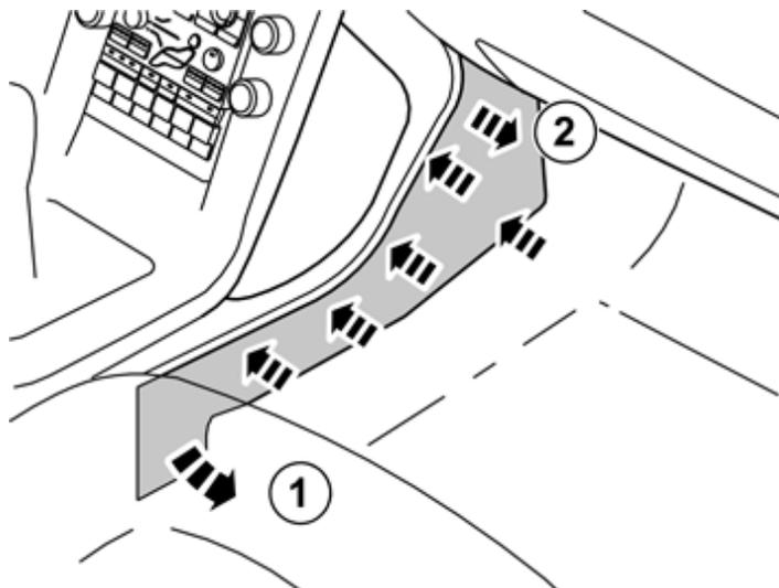
Die rechte Seitenverkleidung der Tunnelkonsole an der Hinterkante beginnend vorsichtig abziehen. Die Verkleidung ist von innen mit fünf Clips befestigt.
