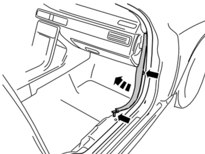
Die untere A-Säulenverkleidung an der rechten Vordertür entfernen. Dazu die Verkleidung zunächst an der Hinterkante hochziehen, bis sich der Clip dort löst, sie dann weiter nach hinten ziehen, bis sich der Clip in der Mitte löst und sie anschließend schräg nach unten von der A-Säulenverkleidung abziehen.
