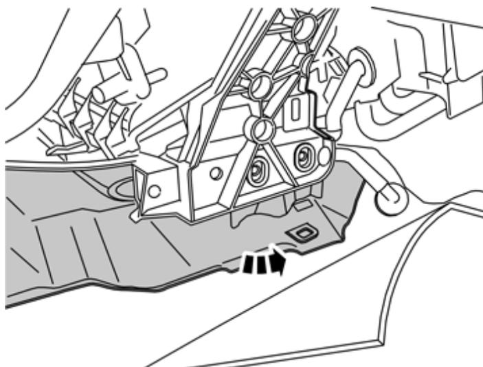
Die Isoliermatte über die Befestigung zurückklappen.
