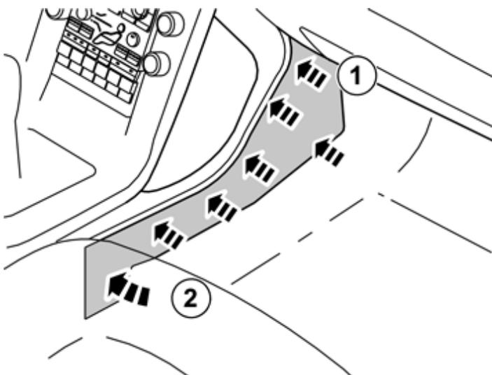
Die Verkleidung der Tunnelkonsole wieder einbauen.
