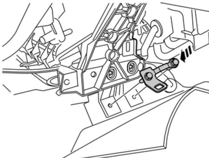
Die größere der Befestigungen aus dem Satz entnehmen und in den Löchern der Befestigung der Tunnelkonsole festziehen.
