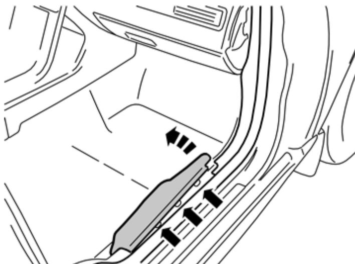
Die Schwellerverkleidung an der rechten Vordertür ausbauen. Diese dazu vorsichtig mit einem Falzbein an der Vorderkante loshebeln und nach oben ziehen, bis sich die drei Clips darunter lösen. Die Verkleidung anschließend nach vorne/oben abziehen.
