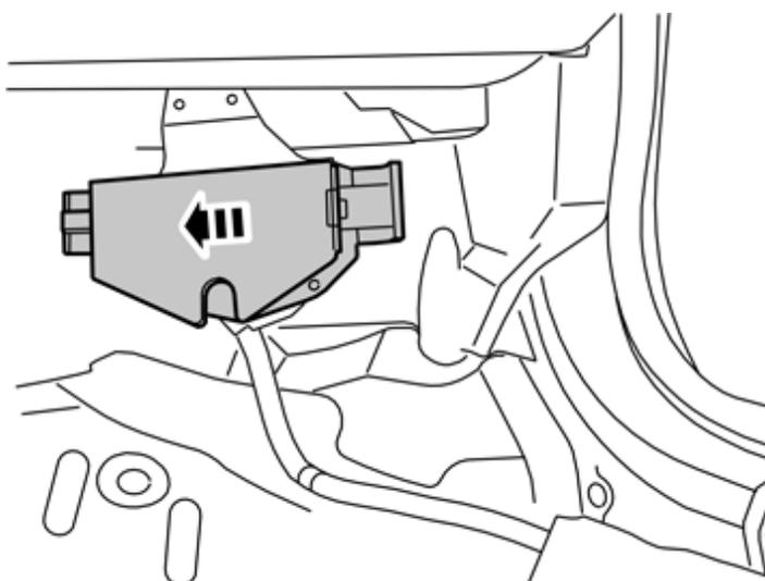
Die Halterung für die Steckverbinder lösen; sie ist mit zwei Clips befestigt.
