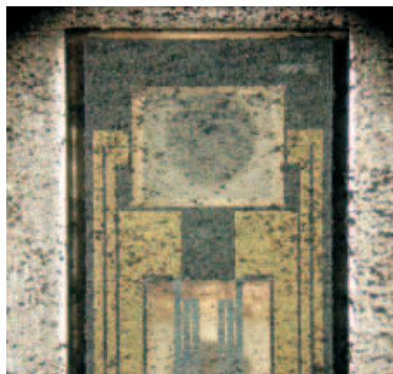
Salz und Schmutz können den Sensor eines Luftmassensensors schädigen – zumindest aber verfälschen sie die Messungen, was sich wiederum auf die AGR auswirken kann.
