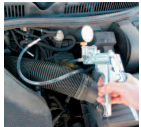
Ob pneumatische AGR-Ventile oder wie hier ein EPW: mit einer Handunterdruckpumpe lässt sich die Funktion leicht prüfen.
