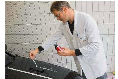
...Pipette mit drei Millilitern Politur und verteilt sie auf der abgeklebten Lackpartie
