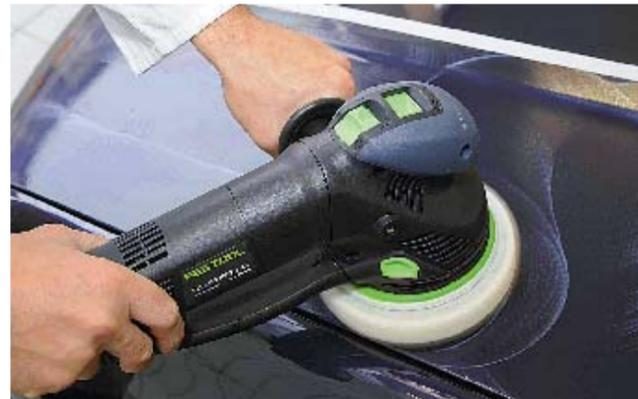
...Bewegungen vor allem für ungeübte Anwender den Vorteil, dass keine Hologramm-Effekte auf der Lackoberfläche entstehen
