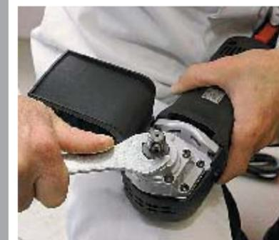
Auf die Spindel mit Standardgewinde (M14) wird der Stützteller aufgeschraubt, der...
