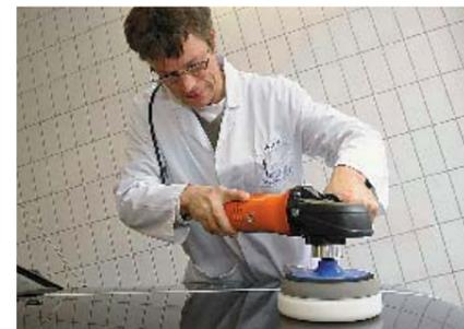
Abgehoben: Der Fein-Polierer arbeitet (zu) weit über der Lackoberfläche
