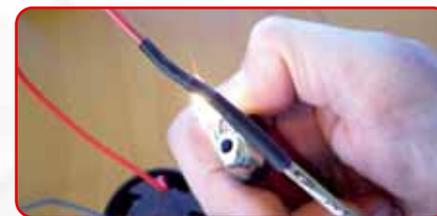
Beim Hochtöner funktioniert das Löten genauso. Die Lötstelle wird mit vorher aufs Kabel gezogenem Schrumpfschlauch bedeckt und dieser mit einem Feuerzeug oder Ähnlichem aufgeschumpft
