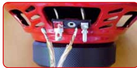
Bevor die Lötverbindung hergestellt wird, sollten die beiden Kontakte verzinnt werden. Dazu den Kontakt mit der Lötspitze erwärmen und so viel Lötdraht in die heiße Kontaktstelle drücken, bis sie gut benetzt ist
