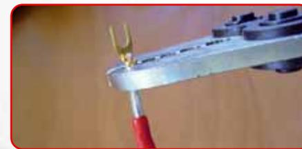
Weil die Weiche ein trockenes Plätzchen bekommt, müssen die Kabel nicht mit der Weiche verlötet werden. Hier erhält man beste Kontaktierung mit Kabel-Kabelschuhen, die mit einer ordentlichen Zange aufgeschumpft werden
