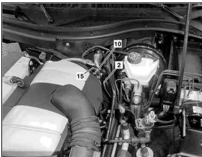
Kühlmittelschlauch (15) zusammenstecken und mit zwei Schraubschellen (10) befestigen.
