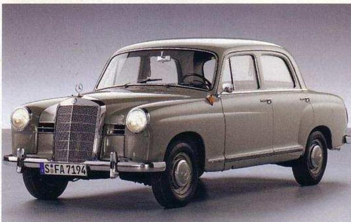
Charakteristika: Die Vierzylinder erkennt man an den aufgesetzten Blinkern, Modelle vor 1959 an Hochkühler und Stoßstangenhörnern.
