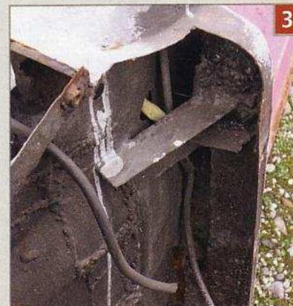
Sch(w)eißarbeit: An den vorderen Kotflügeln wird gerne gepfuscht.
