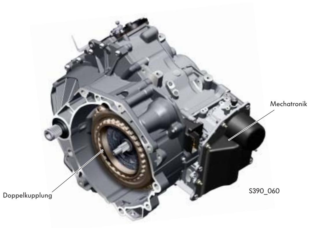
Die trockene Doppelkupplung hat als Konstruktionsmerkmal wesentliche Auswirkungen auf das gesamte Getriebekonzept. Durch das neue Getriebekonzept konnte im Vergleich zum Direktschaltgetriebe 02E der Wirkungsgrad nochmals deutlich verbessert werden.
