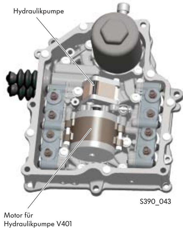
Die Hydraulikpumpe arbeitet nach dem Prinzip einer Zahnradpumpe. Sie saugt das Hydrauliköl an und drückt es mit einem Druck von ca. 70 bar in den Ölkreislauf.
