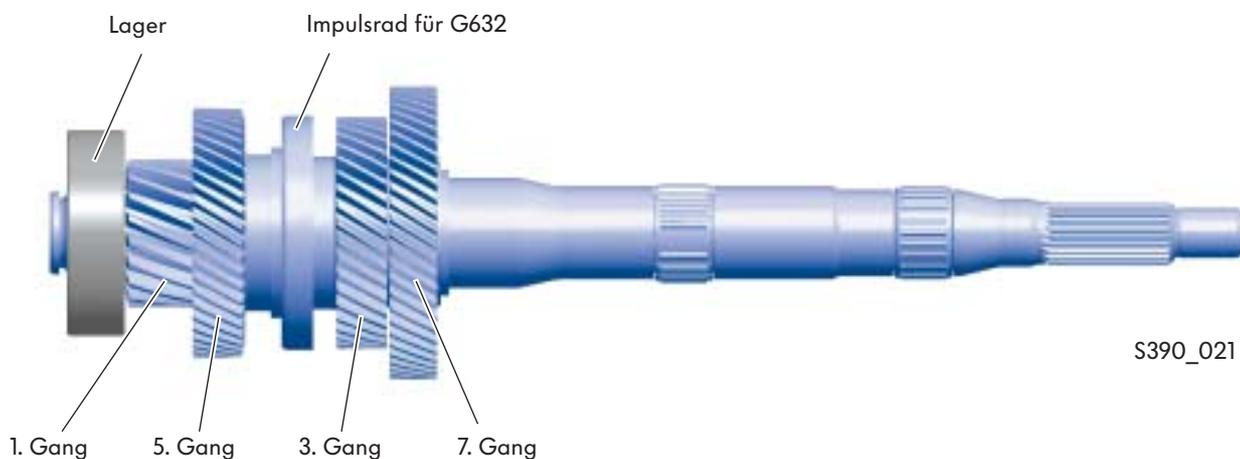
Die Antriebswelle 1 ist durch eine Steckverzahnung mit der Kupplung K1 verbunden. Über sie werden die Gänge 1, 3, 5 und 7 geschaltet. Zur Erfassung der Getriebeeingangsdrehzahl befindet sich auf dieser Welle ein Impulsrad für den Geber 1 für Getriebeeingangsdrehzahl G632.
