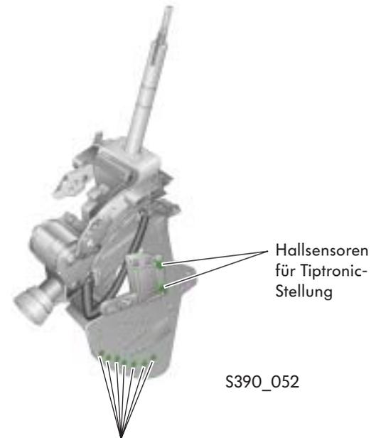
Hallsensoren zur Erkennung der Wählhebelstellung
