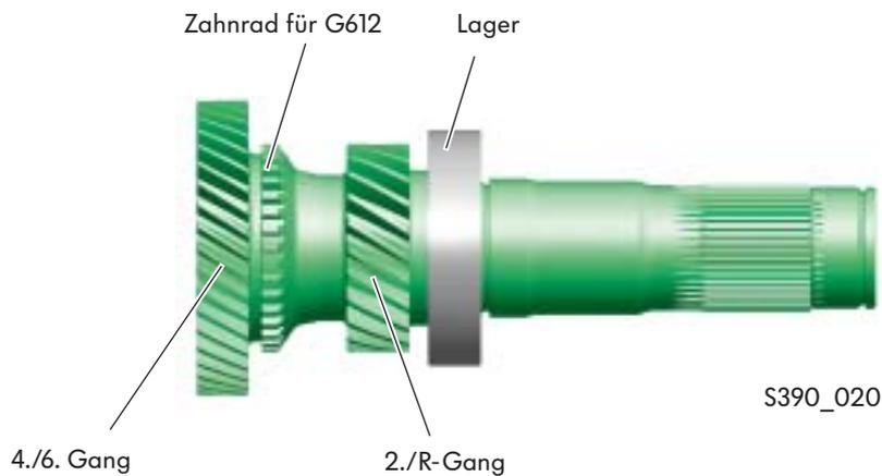
Die Antriebswelle 2 ist als Hohlwelle ausgeführt. Sie ist über eine Steckverzahnung mit der K 2 verbunden. Über die Antriebswelle 2 werden die Gänge 2, 4, 6 und R geschaltet. Zur Erfassung der Getriebeeingangsdrehzahl befindet sich auf dieser Welle das Zahnrad für den Geber 2 für Getriebeeingangsdrehzahl G612.
