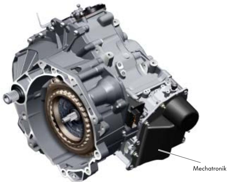
Das elektronische Steuergerät der Mechatronik ist die zentrale Steuereinheit des Getriebes. In ihm laufen alle Sensorsignale und alle Signale anderer Steuergeräte zusammen, und von ihm werden alle Aktionen eingeleitet und überwacht.
