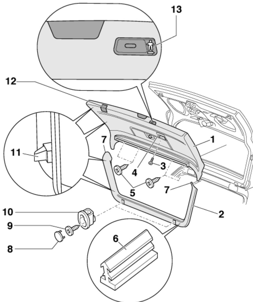
1 - Verkleidung Heckklappe unten
