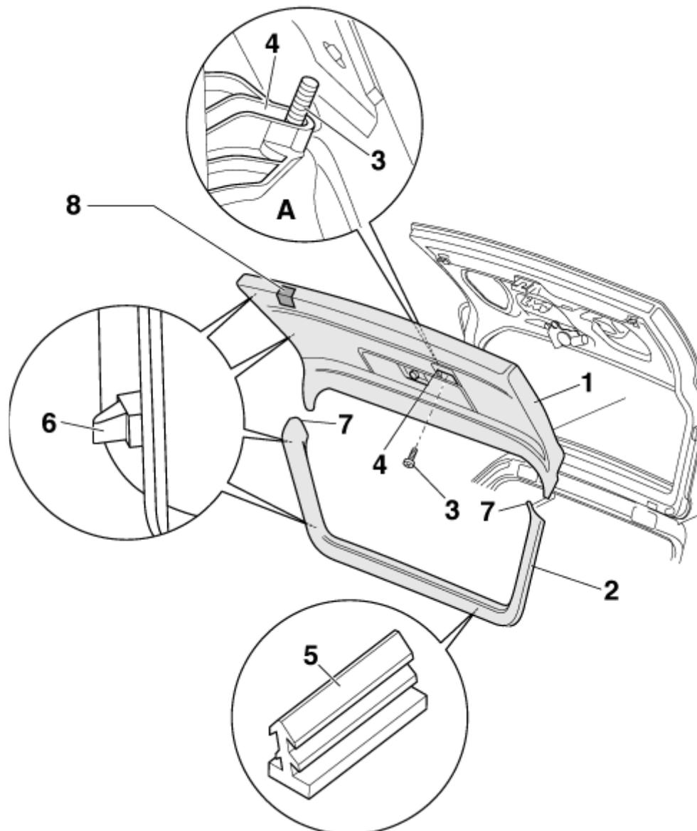
1 - Verkleidung Heckklappe unten
