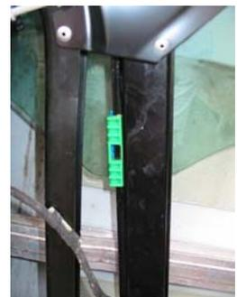
In der Fensterscheibe befindet sich ein Loch, durch das die Scheibe von hinten mit einer Torxx-Schraube am Mitnehmer festgeschraubt ist.
