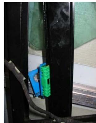
Jetzt wird er links herum aus der Laufschiene gehebelt (geht ganz leicht – kein Werkzeug nötig).
