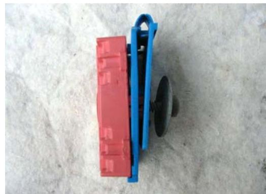
Einbau des neuen Mitnehmers geschieht in umgekehrter Reihenfolge des oben beschriebenen Ausbaus. Beim einclipsen auf die Laufschiene darauf achten, dass der Seilzug nicht unter dem Mitnehmer eingeklemmt wird (einfach etwas mit den Fingern zur Seite ziehen).
