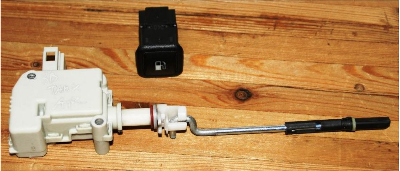
An den Originalhebel habe ich eine Mutter geschweisst, man kann natürlich auch eine Öse biegen, oder was auch immer. Dann noch eine Gummiunterlage, damit nichts dröhnt / klappert. Der Anschluss geht mit schmalen Steckern aus dem Zubehör und etwas Schrumpfschlauch, oder man besorgt sich das originale Steckergehäuse und einen passenden Leitungssatz.
