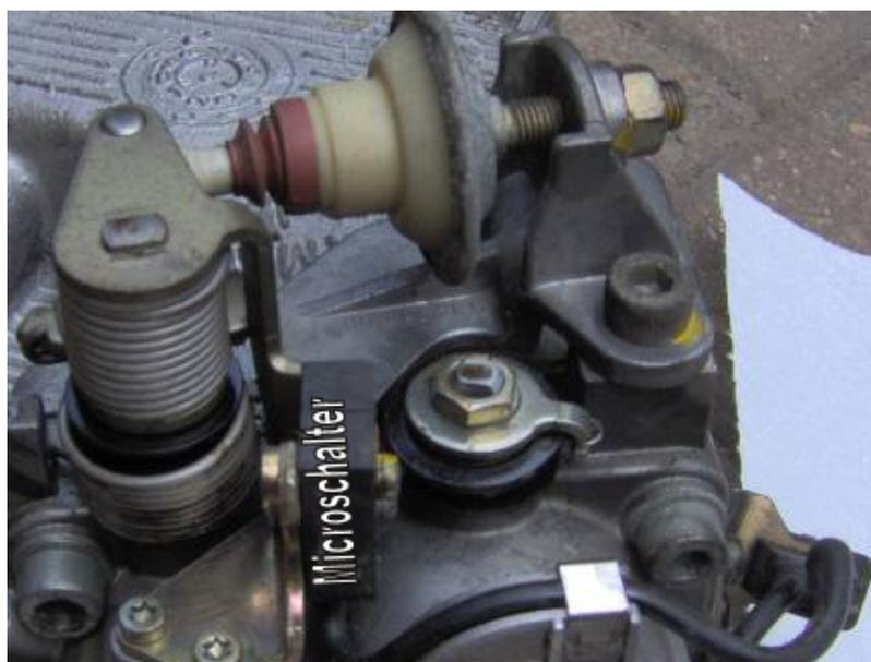
Der Leerlaufregler hat die Aufgabe, je nach Signal des Steuergeräts einen Bypass-Luftkanal um die Drosselklappe herum mehr oder weniger zu öffnen und damit den Leerlauf zu regeln.
