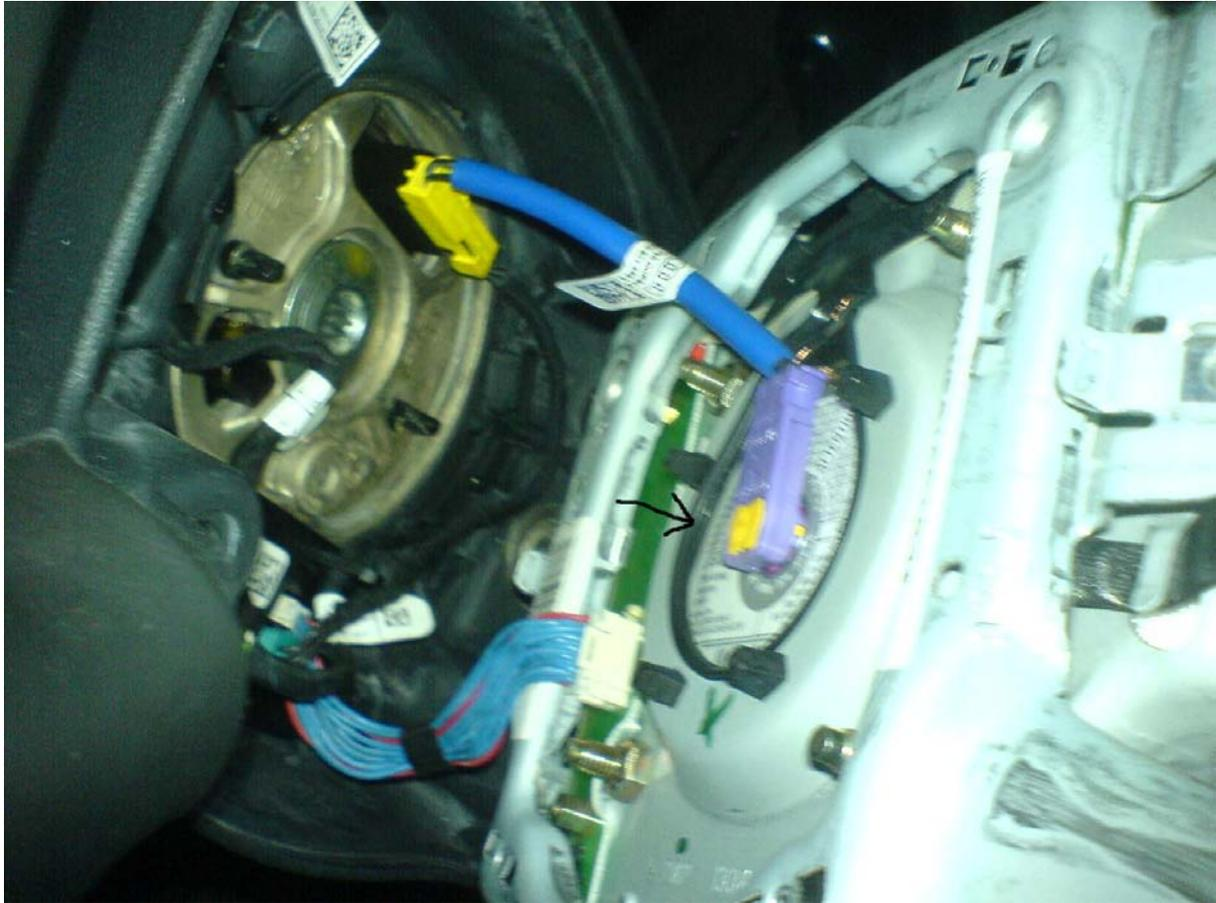
Dies ist das besagte Kabel. Hier müsst ihr mit einem kleinen Schraubenzieher den gelben Sicherungsbügel auf dem Schalter rausziehen, danach kann man den Stecker einfach abziehen!
