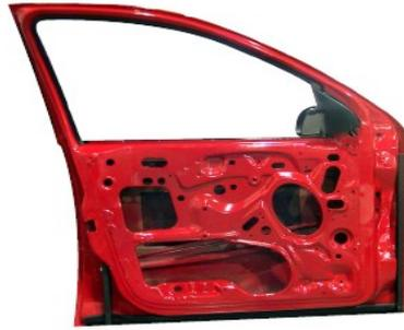
Schritt A : die Türverkleidung wird abgenommen und die originalen Lautsprecher ausgebaut. Dann werden alle Folien und Schaumstoffe aus der Tür entfernt. Anschließend werden alle Blechflächen mit Verdünnung oder Bremsenreiniger und Lappen gereinigt, auch innen in der Tür !
