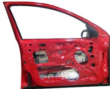
Schritt B: die Alubutyl-Matten werden zuerst zugeschnitten und dann im Türinneren verklebt. Diese Fläche sollte dann noch mit einer Schicht aus geschlossenzelligem Schaum beklebt oder dauerelastischer Dämpfpaste bestrichen werden ! Erforderliche Werkzeuge : Teppichmesser, Tapezierroller. Als Hilfsmittel vielleicht noch ein Kissen zum Draufknien und eine Schneideunterlage (Holzplatte)
