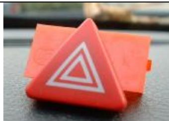
Beim Aufstecken des Gehäuses zeigte sich, dass die Tücke wieder eindeutig im Detail liegt. Auch nach mehreren Anläufen gelang es mir nicht, die Elektronik wieder so in das Gehäuse zu schieben, dass vorne die Federn und der Auslösepinn in der Tastkappe korrekt einrasteten, weil vermutlich die Nase der Elektronik mit den Leuchtdioden für den Warnblinkschalter nicht so recht durch die passgenaue Aussparung in der Tastkappe rutschte.
