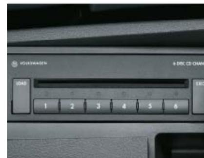
Der **CD-Wechsler** in der Mittelarmlehne vorn nimmt Ihnen das Einlegen von Audio-CDs ab und bietet Platz für bis zu sechs Tonträger. Er kann über das Bedienelement des Radio-Navigationssystems gesteuert werden.
