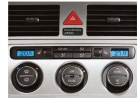
Die Klimaanlage „Climatronic“ regelt die Temperatur elektronisch und teilt den Innenraum in zwei Klimazonen für Fahrer- und Beifahrerseite. Temperatur, Luftzufuhr und -verteilung können individuell eingestellt werden.
