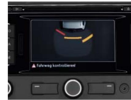
Durch die Kombination des Radio-Navigationssystems „RNS 310“ mit dem **ParkPiloten** warnt Sie der Touran R-Line Edition beim Einparken neben den akustischen Signalen auch durch eine optische Anzeige im Radiodisplay vor Hindernissen im Heckbereich.
