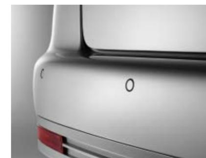
Der ultraschallbasierte **ParkPilot** im hinteren Stoßfänger sendet die Impulse für die akustische und optische Abstandsanzeige.
