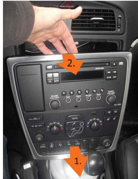
Abbildung 8: Klima-Radio-Konsole herausziehen
