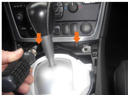
Abbildung 7: Halteschrauben der Konsole entfernen
