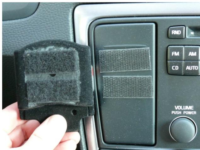
Abbildung 14: Brodit-Halterung mit Klettstreifen
