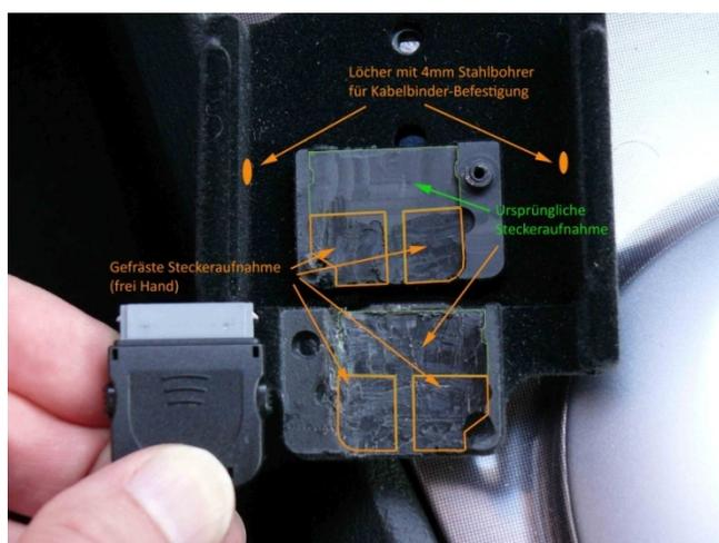
Abbildung 12: Brodit-Halter mit Ausfräsungen
