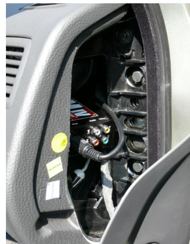
Abbildung 10: Vorschlag zur Einbauposition des iMIV-Adapters
