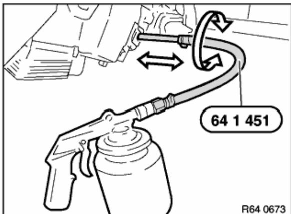
Sprühlanze 64 1 451 mit Sprühgerät verbinden. Durch Hin- und Herbewegen der Sprühlanze 64 1 451 das Reinigungsmittel gleichmäßig auf den Verdampfer aufbringen. Hinweise zum Reinigungsmittel sowie zum Nachspülen siehe Service Information.
