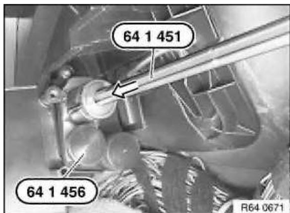
Sprühlanze 64 1 451 in Pfeilrichtung einführen und mit
