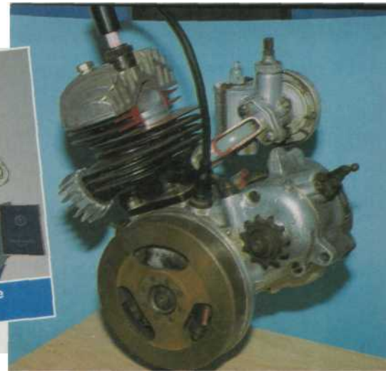
Stückzahlkönig: Das Schnittmodell zeigt den einfachen Aufbau des 98er Fichtel & Sachs
