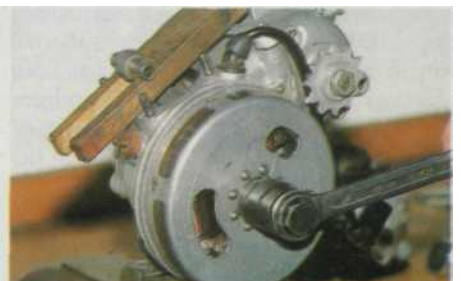
Die Schraube des Abziehers drückt das Rad von der Welle, das Holz hindert die Welle am Drehen
