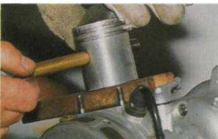
Mit passendem Durchschlag wird der erwärmte Kolbenbolzen ohne Kraftaufwand ausgetrieben
