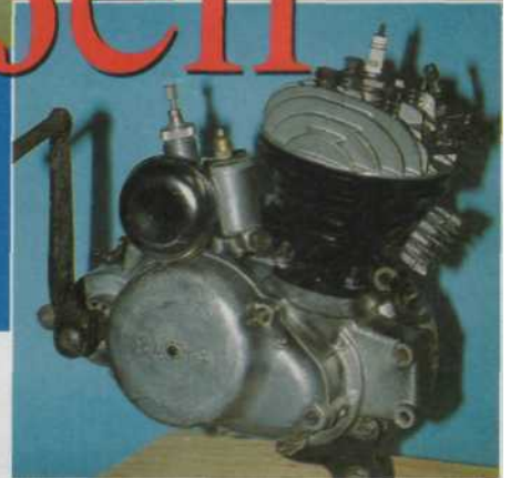
Seltenes Stück: 98 M 32 mit Kickstarter. Für ihn mussten Gehäuse und Deckel geändert werden
