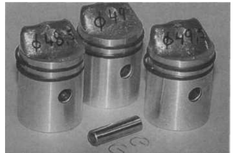
Moderne Zeiten: Nachgefertigte Qualitätskolben sind heute in drei Übermaßen erhältlich
