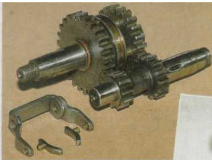
Die Hauptwelle des Getriebes lässt sich nach oben herausziehen (links). Einfacher geht's kaum: die simple Zweigang-Schaltbox (oben)
