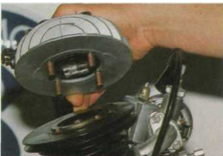
Der erste Schritt: Abheben des Zylinderdeckels. Eine Dichtung gibt es an dieser Stelle nicht!
