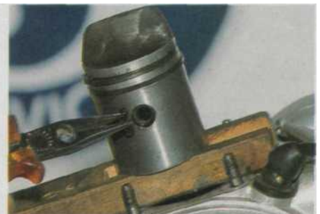
Die Kolbenbolzensicherung wird entfernt. Ein Hartholz mit Nut sorgt für sichere Auflage
