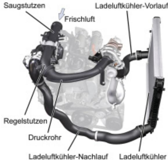
**Bild 24:** Luftführende Bauteile
