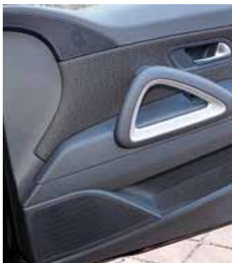
Gleichstand: Nicht nur die Werkslautsprecher, auch die Speaker des Nachrüstsystems sitzen in den Original-Einbauplätzen.
