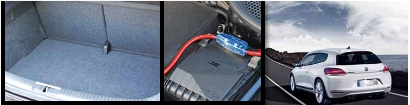
Clean Park: Im Kofferraum ist von der Nachrüstanlage nichts zu sehen; er ist dank stabiler Bodenplatte voll nutzbar (links). Nur das dicke Stromkabel an der Batterie mit der klassischen Sicherung deutet auf die Anlage hin (rechts).
