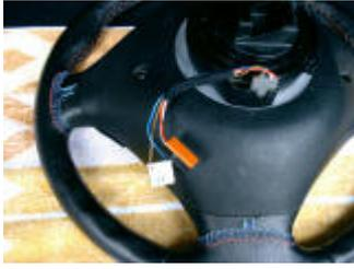
Man sieht, das der Hupkontakt des neueren Lenkrades auch über die Wickelfeder realisiert ist (weißer Stecker). Das blaue Kabel ist der Masseanschluß des Lenkrades, das braune Kabel führt zum Hupenrelais. Durch drücken der Airbagprallplatte wird das braune Kabel auf Masse gelegt und so die Hupe betätigt. Das ältere Modell hat noch einen konventionellen Schleifkohlenkontakt für diese "schaltbare Masse", die Massequelle war die Lenksäule selbst.
