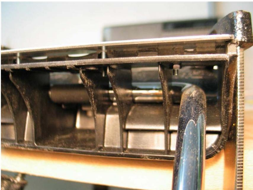
Aluprofil mit den M3 Schrauben befestigen.
