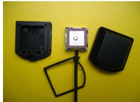
Zum Ausbau der alten, defekten Antenne muß die Innenleuchte im Laderaum ausgeclipst werden. Mit einem Maulschlüssel SW22 kann man von dort aus eine Befestigungsmutter lösen und die Antenne etwas nach oben aus dem Dach heraus ziehen. Die Anschlußkabel der Antenne sind rund 30 cm lang. Man kann die Kupplungen in der Dachverkleidung suchen und lösen, um die Antenne komplett auszubauen. Man kann aber auch auf dem Autodach löten.
