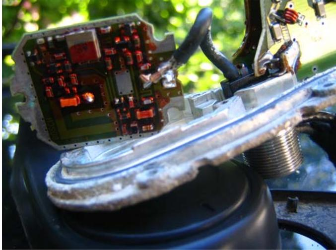
Jetzt muß man „nur noch“ das Anschlußkabel der alten Antenne an die neue Platine löten. Dabei am besten erst die Abschirmung des Kabels anlöten und dann die Seele. Danach das Abschirm-Gehäuse wieder aufsetzen und verlöten. Jetzt kann die neue Antenne einem ersten Funktionstest unterzogen werden. Carport- oder Garagedächer schirmen die Satellitensignale ordentlich ab, also dazu lieber raus fahren.
