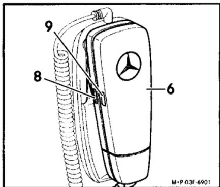
3. Am Hörer (6) Rändelrad (8) ca. 3 Sekunden drücken, ohne das Rändelrad (8) dabei zu verdrehen. Die Leuchtdiode (9) blinkt in schneller Frequenz. Im COMAND-Display erscheint eine Meldung, dass das Telefon aktiviert wird.
