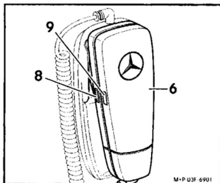
3. Am Hörer (6) Rändelrad (8) ca. 3 Sekunden drücken, ohne das Rändelrad (8) dabei zu verdrehen. Die Leuchtdiode (9) blinkt in schneller Frequenz, im Display des Audio-Systems erscheint **WAIT...**
