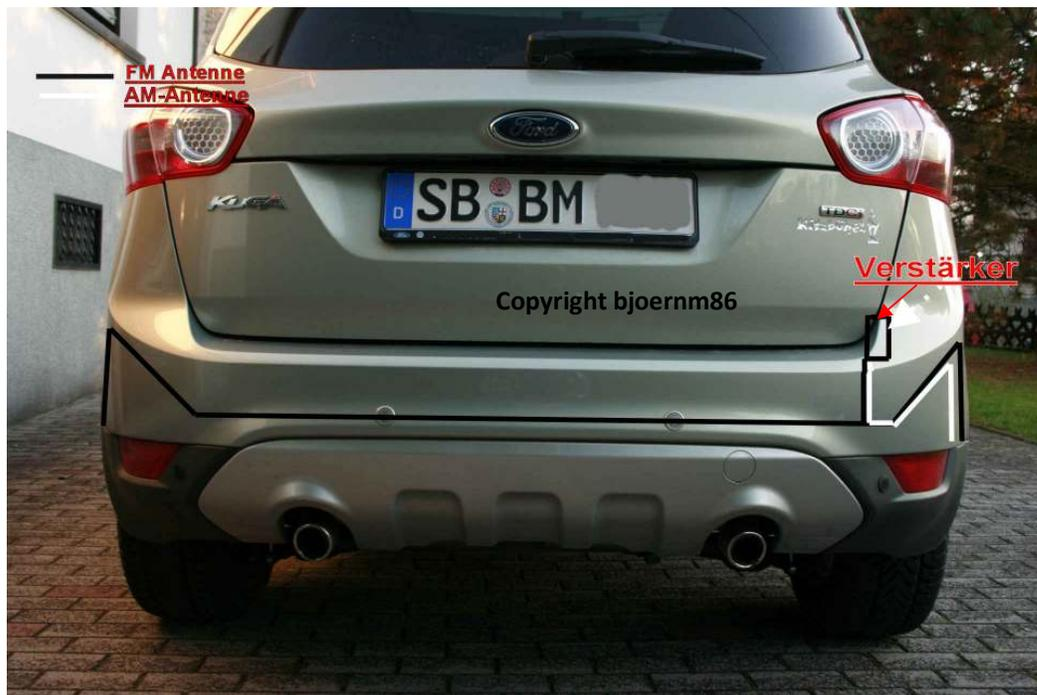
Wichtig das Ende der Antenne mit den Anschlusssteckern muss auf der Beifahrer Seite hinten unter der inneren Verkleidung unter dem Parktronic Modul heraus kommen. Dazu muss der Gummi, um in den Innenraum zu gelangen, 2 Löcher rein gemacht werden.
