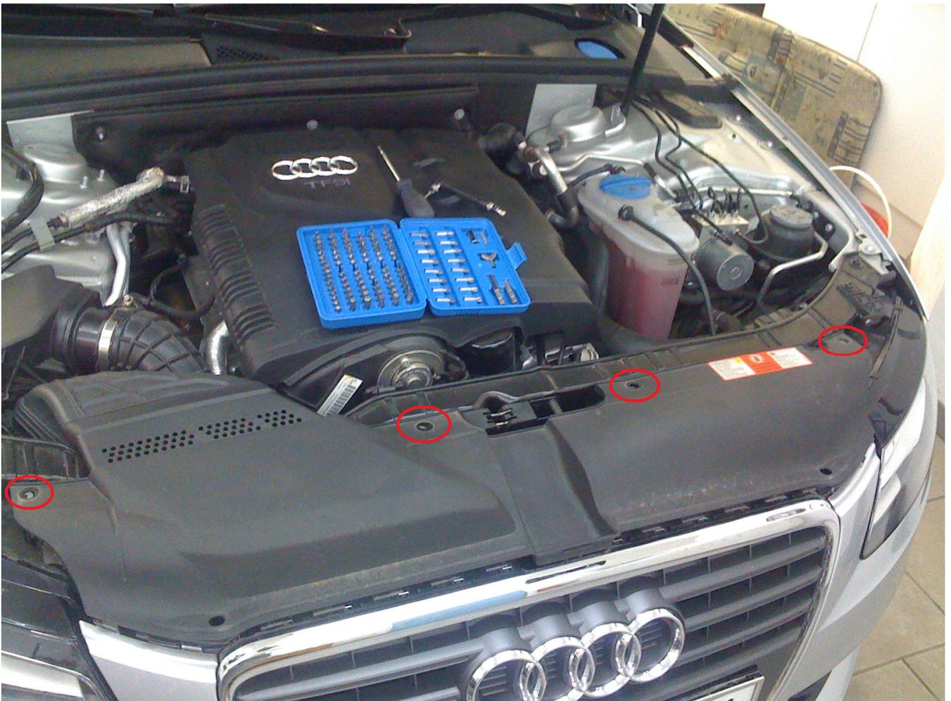
Die Abdeckung ist an der Frontseite ein wenig unter die Chromleiste des Grills geschoben. Kleine Bewegung nach hinten löst diese ganz einfach ab! Nicht vergessen, beim Zusammenbauen wieder hier hinein zu schieben!
