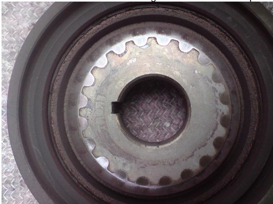
Passt es nicht in beide Nockenwellen gleichzeitig rein, Nockenwellenräder wieder gegen verdrehen arretieren (!), Nockenwellenrad der Nockenwelle mit Fehlstellung lösen, mit geeignetem Mittel die Nockenwelle von Hand drehen, bis das Lineal passt. Nockenwellenrad wieder mit 70Nm festziehen. Arretierung lösen. Wieder von Hand drehen und Prüfvorgang wiederholen.
