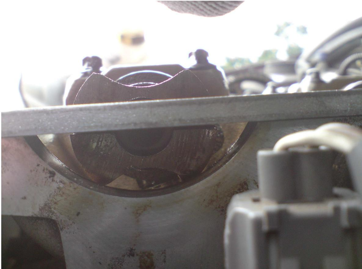
Rad montieren, Wagen ablassen, 1.Gang einlegen und ggf. von Helfer Bremse kräftig treten lassen. Nun die Riemenscheibe an der Kurbelwelle lösen und abmontieren (Achtung! Hohes Lösemoment!). Man kann auch mit einem alten Keilriemen und einer Schraubzwinde die Riemenscheibe gegenhalten.
