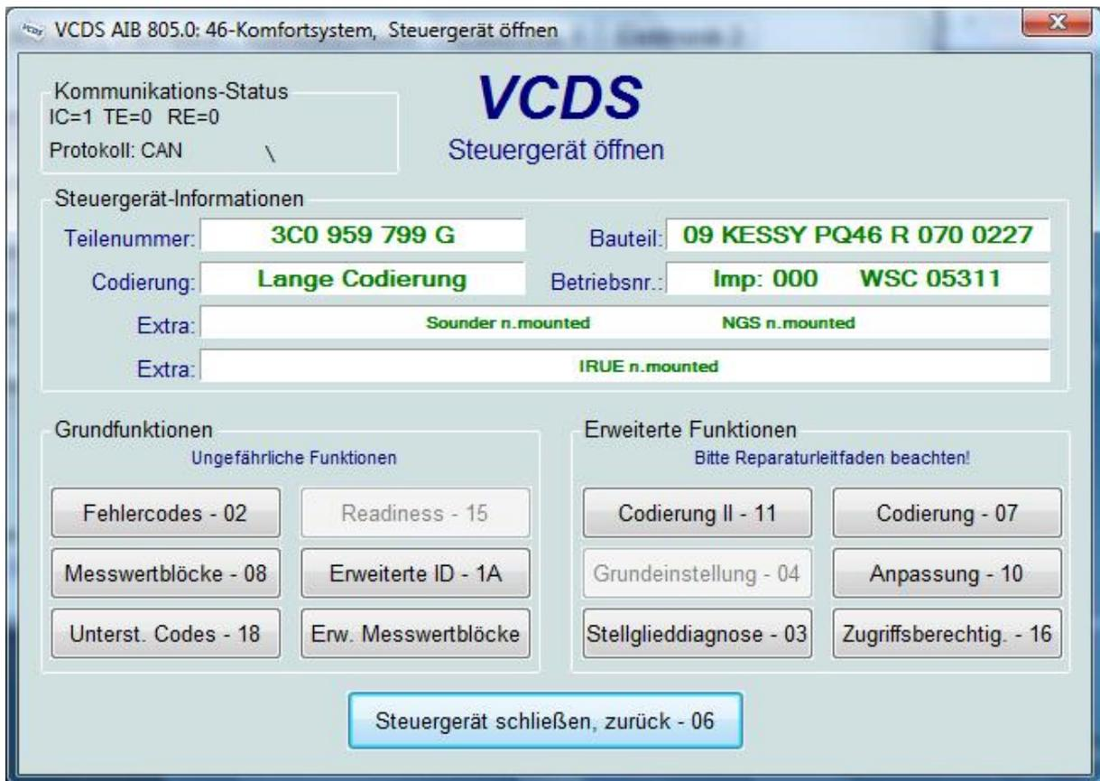
In diesem Steuergerät ist als Standard eine lange Codierung abgelegt:
