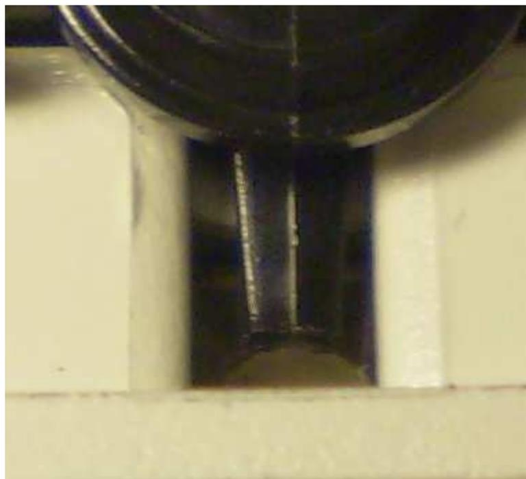
Man braucht also lediglich ein Verbindungsstück zwischen Plastikstift und Knopf. Ich habe dafür ein Stück von einem Gumminippel abgeschnitten, den man normalerweise dazu benutzt, um einen Gehäuselüfter von einem PC zu entkoppeln:
