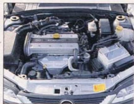
**Das Motor-Maß der Vernunft: vier Zylinder, 1,8 Liter Hubraum, 16 Ventile und 115 PS. Mit Kombi-Talenten: der schräge Vectra**
