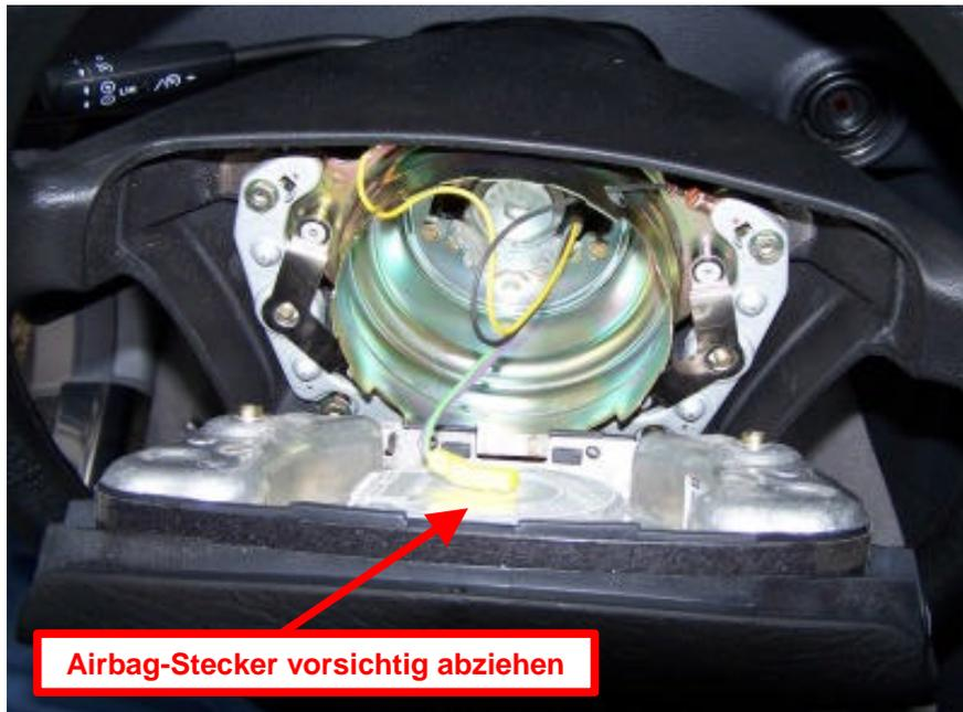
Nun werden die Stecker der Hupe abgezogen (sie sind mit einer kleinen „Nase“ gesichert). Außerdem müssen die gelbe und die schwarze Leitung nach innen geholt werden, damit sie zur Entnahme des Lenkrades nicht beschädigt werden.
