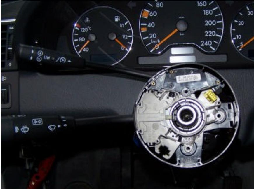
Der Stecker des Tempomathebels wird am Zündschloss eingesteckt. Dort kommt man am besten von unten dran, aus diesem Grund wurde anfänglich die Fußverkleidung demontiert.
